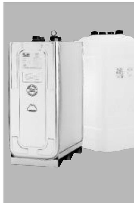
конфигурации с помощью фикспакетов В (блочных) или L (угловых). В топливных баках Roth предусмотрено четыре одинаковых отверстия диаметром 85 мм: для заливки топлива, для деаэрации, для забора топлива на горелку и резервное. Модели KWT имеют сертификат о прохождении 30-минутных и DWT – 90-минутных огневых испытаний.
